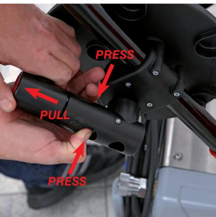
**3a) Entriegeln der Schlauchtrommel:**
