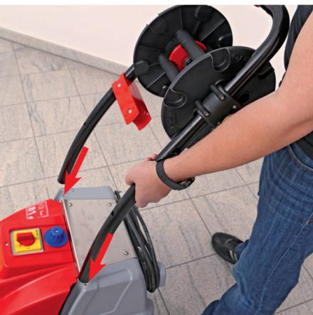
**1. Montieren des Schubbügels:**
