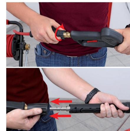
**7. Schlauch, Pistole und Lanze montieren:**
