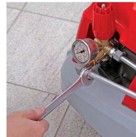
**6a) Montieren der Verbindungsleitung:**
