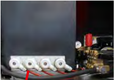
triplex-zuigerpomp met messing-pompkop, keramische-plunjers en RVS-ventielen
