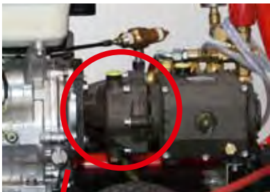
aanrijving voor reducering van het pompen toerental (reduc. overbrenging 1: 2,2)
