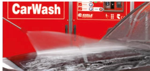
Der Klarspülvorgang spült die Reinigungsmittelreste des ActivePower Pearl MicroPulvers<sup>®</sup> und gelösten Schmutz mit kaltem klarem Wasser ab. Optional kann das Klarspülprogramm mit entkalktem oder demineralisiertem Osmose-Wasser betrieben werden.
